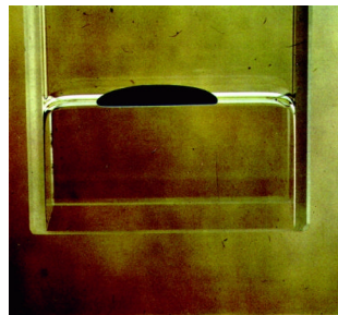
Fig.2 Le stesse gocce di fig.1 distese con aggiunta di tensioattivi
