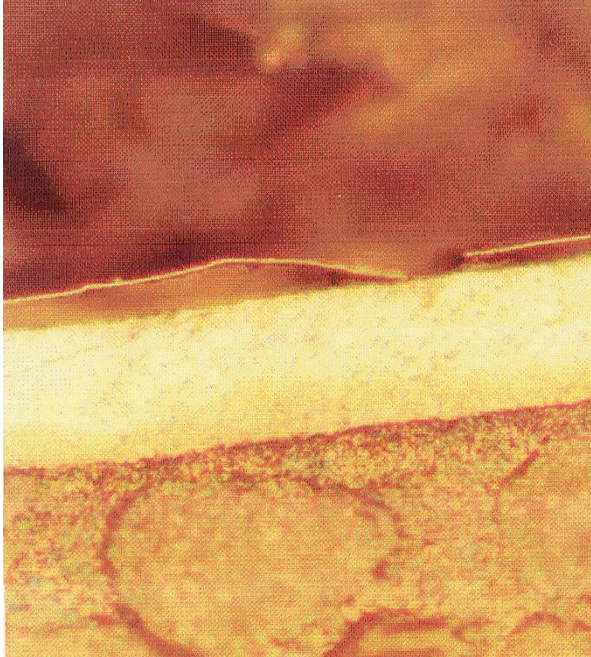
*Nichel semilucido colonnare + lucido lamellare dopo intacco con Nital 10"
